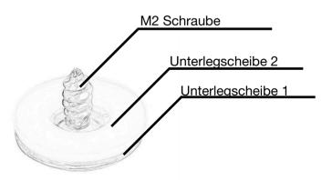
Als erstes wird die Schutzfolien der Klebestreifen entfernt. Anschließend werden die Paddles so angebracht, dass die Positionen der Löcher mit deren des Gehäuses übereinstimmen. Anschließend mit einen leichten Druck, dass Ganze Verkleben. Auf der Innenseite des Gehäuses werden nun die zwei mitgelieferte Schrauben mit Hilfe zwei Unterlegscheiben Verschraubt.
