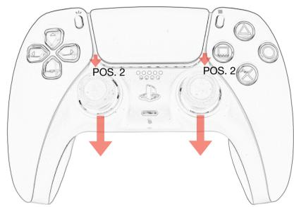
Klappe das Zwischencase an den unteren Controller Ende POS. 1 auf und ziehe das Zwischencase langsam nach oben. Sobald das ganze gelöst ist, ziehe das Zwischencase nach unten um die Pins POS. 2 aus der Touchpad LED Leiste zu lösen.
