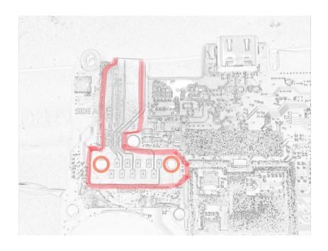
Als erstes wird die Schutzfolien der Klebestreifen entfernt, der Remapper wird so Positioniert das die rot markierte Löcher übereinstimmen.
